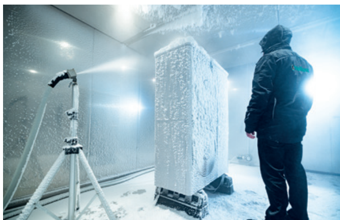
Zkušební týmy testují provoz v klimatických komorách za extrémních podmínek
