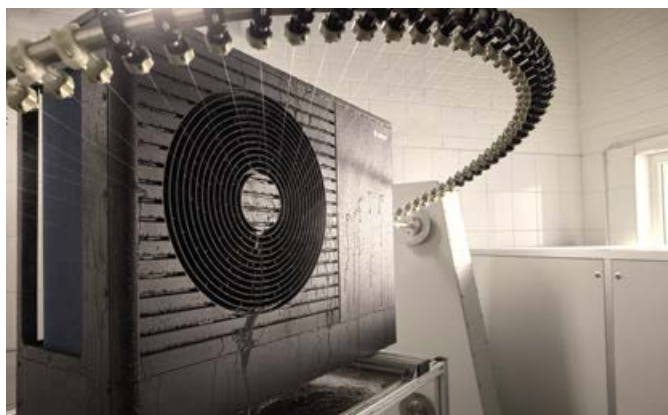
Test odolnosti proti střikající vodě pro ochranu i při extrémních srážkách
